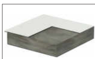
ásványi gyapot ( U = 0,91 \text{ W/m}^2\text{K} )
