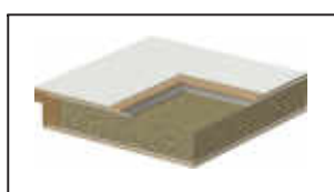
tele faforgácsbetét + alumínium betét
