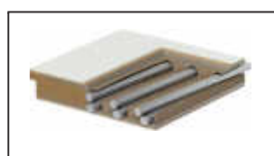
furatolt faforgácsbetét + acél rudak + alumínium betét
