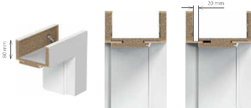
ajtó tok profil – 80 mm széles takaróléccel
