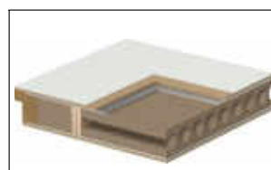
furatolt fagorgácsbetét + ólomréteg (Röntgen)
